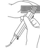
Escovar toda a superfície externa com uma escova de nylon macia, umedecida com a solução de limpeza mencionada anteriormente. Com uma escova espiral, realizar a limpeza do conector de sucção, fazendo movimentos vai e vem.
