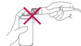
Não inserir o lubrificante no orifício de encaixe dos acessórios.
