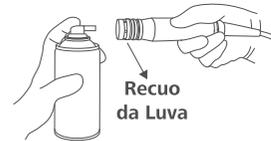
**Recolocar a tampa de proteção.** Aplicar o lubrificante (óleo mineral de baixa viscosidade, por exemplo MaqSpray), na luva de acesso do Micro Motor Elétrico. Em seguida retirar o excesso do lubrificante com uma toalha de papel.
