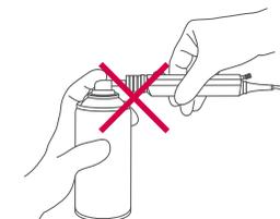
Não inserir o lubrificante no orifício de encaixe da Cânula de Microdebridação.
